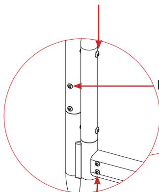
b) Sichern Sie alle Befestigungsschrauben des großen U-Rohrs.
